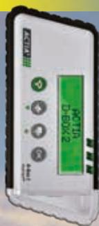
Les cartes chauffeurs sont téléchargées directement par la D-Box 2 sans que celle-ci ne soit raccordée au tachygraphe.
